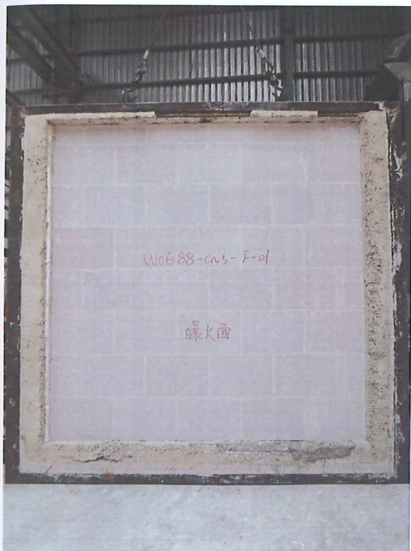
照片 3 加熱試驗前試體曝火面
