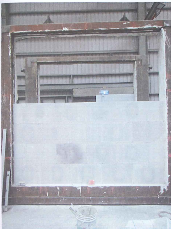
照片 1 試體組裝過程(輕質磚安設)
