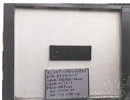
圖 25、吊掛約 50kg 之荷重測試後後視圖(試體配置呈 0 度)
