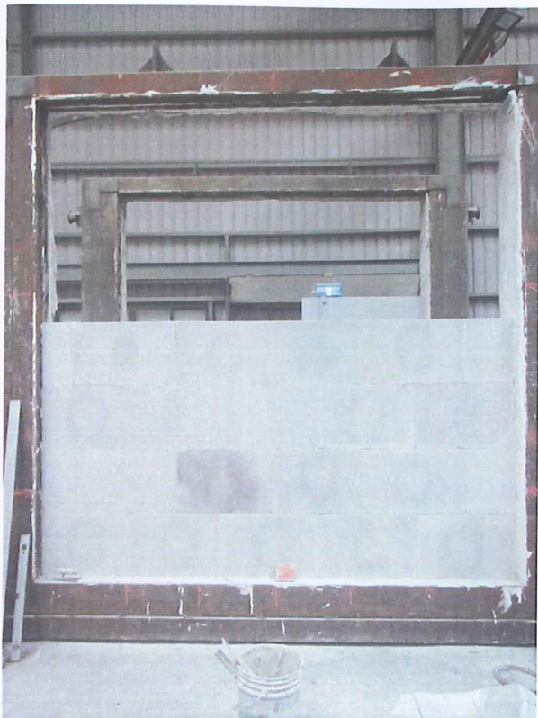
照片 1 試體組裝過程(輕質磚安裝)
